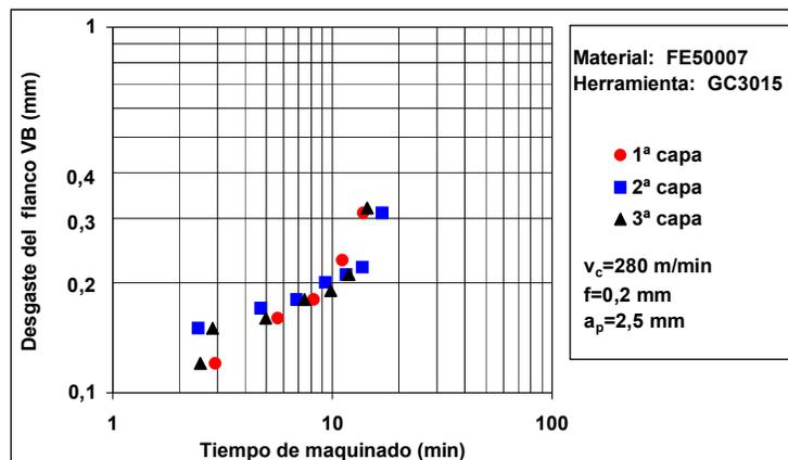
Fig. 6: Curvas de desgaste del flanco em función del tiempo de maquinado, empleándose herramienta GC 3015 y velocidad de 280 m/min
