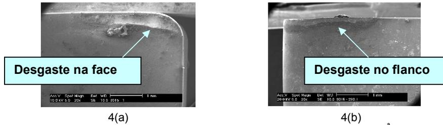
Fig. 7: GC3015 – Vista de la cara (a) y vista del flanco (b) de la herramienta, 1ª capa, 280 m/min (20x)
