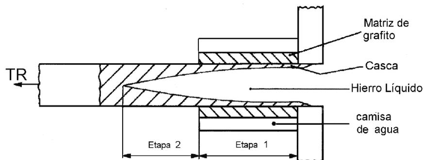
Fig. 2: Esquema del proceso de fundición continua
