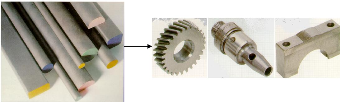
Fig. 1: Ejemplos de piezas producidas a partir de perfiles de hierros fundidos
