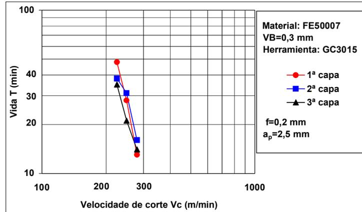
Fig. 8: Curvas de vida para las tres capas del hierro fundido nodular y para las tres velocidades de corte, VB de 0,3 mm
