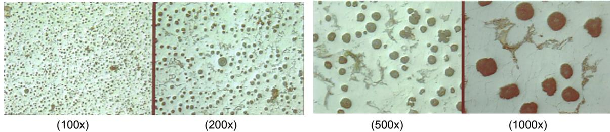
Fig. 3: Microestructura de hierro fundido nodular FE-50007, en la profundidad de 3,5 mm. Reactivo: nital a 2%
